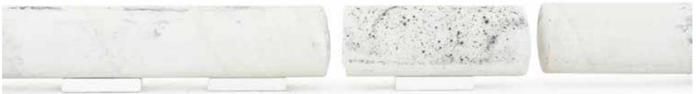
En géologie, on prélève des échantillons dans le sol en forant à l'aide de machines et de tubes creux. Les cylindres qu'on obtient s'appellent des **carottes**, ils sont étudiés par des scientifiques.
